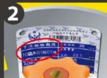
合格標示遭塗改、污損
